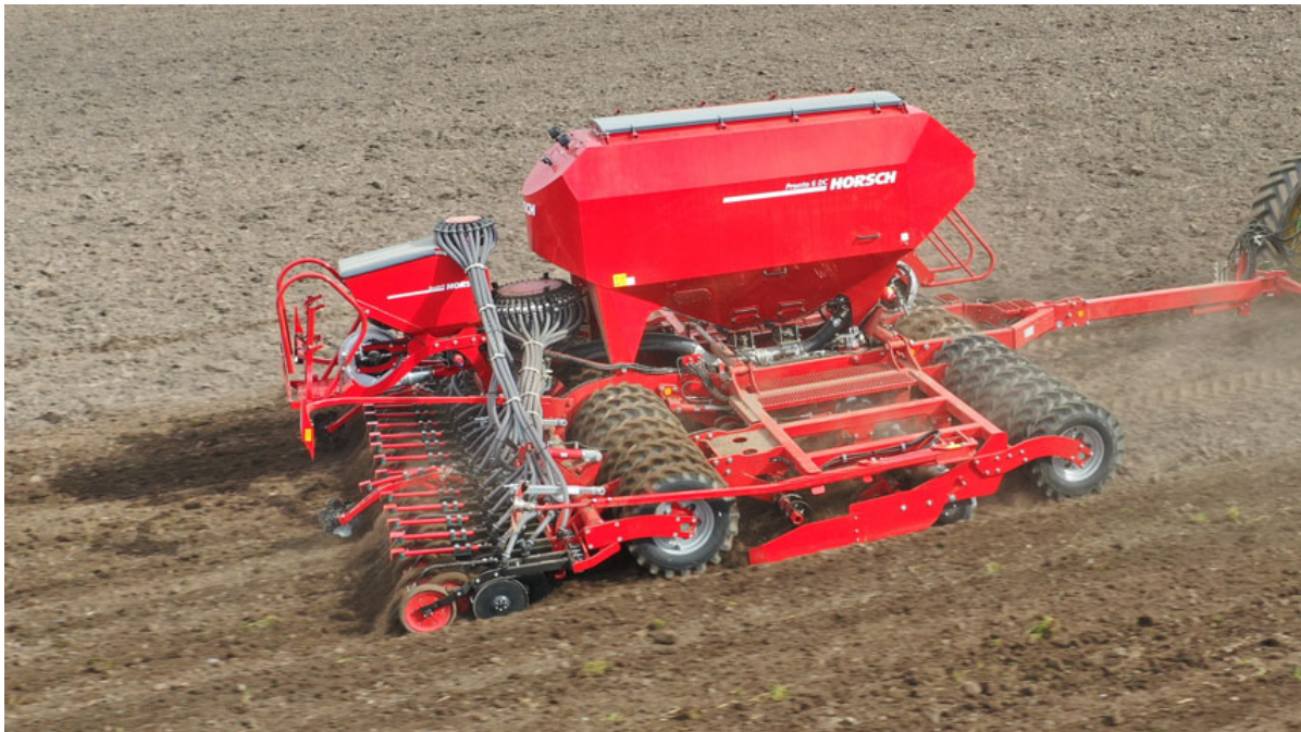
Figur 1. Horsch Pronto med samsåning af gødning og såsæd i samme såskær. Horsch.
